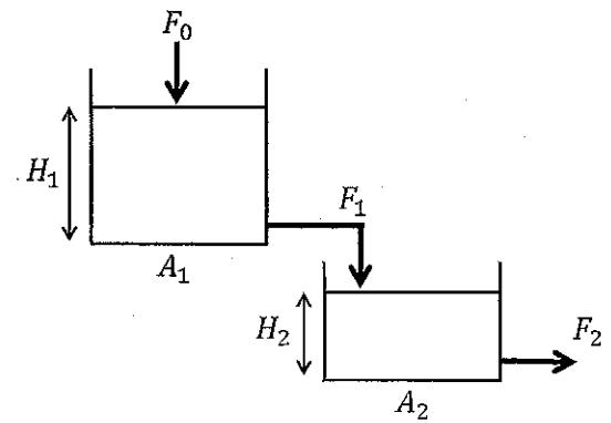
(a)  $\Delta H_1$ および $\Delta H_2$ の時間変化を表す微分方程式は以下のようになる。式(1)のみを導出せよ。
