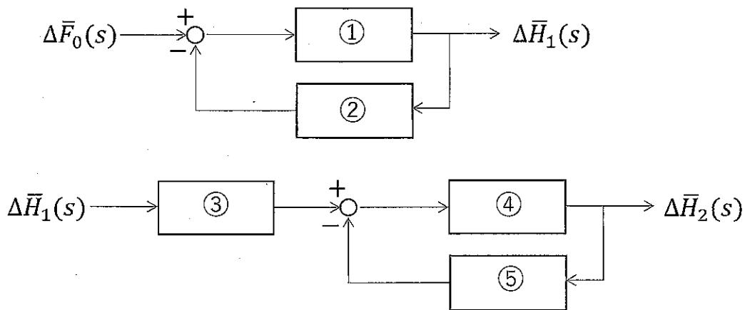
(d) 問(c)の2つのブロック線図を統合した後、等価変換により簡略化し、 $\Delta \bar{F}_0(s)$ を入力、 $\Delta \bar{H}_2(s)$ を出力とする伝達関数を求めよ。なお、ブロック線図の統合および簡略化の過程も描くこと。
