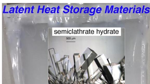
潜熱蓄熱材料として注目されているセミクラスレートハイドレート
