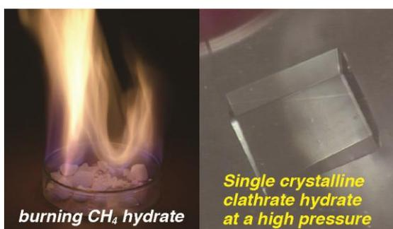
燃えるメタンハイドレート(左)と分光測定用高压容器内のガスハイドレート単結晶(右)
