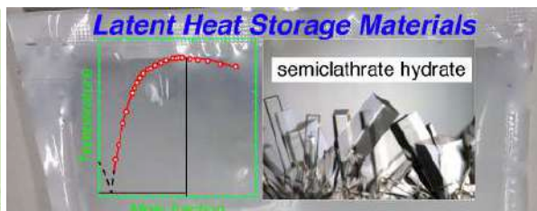
潜熱蓄熱材料として注目されるセミクラスレートハイドレート
